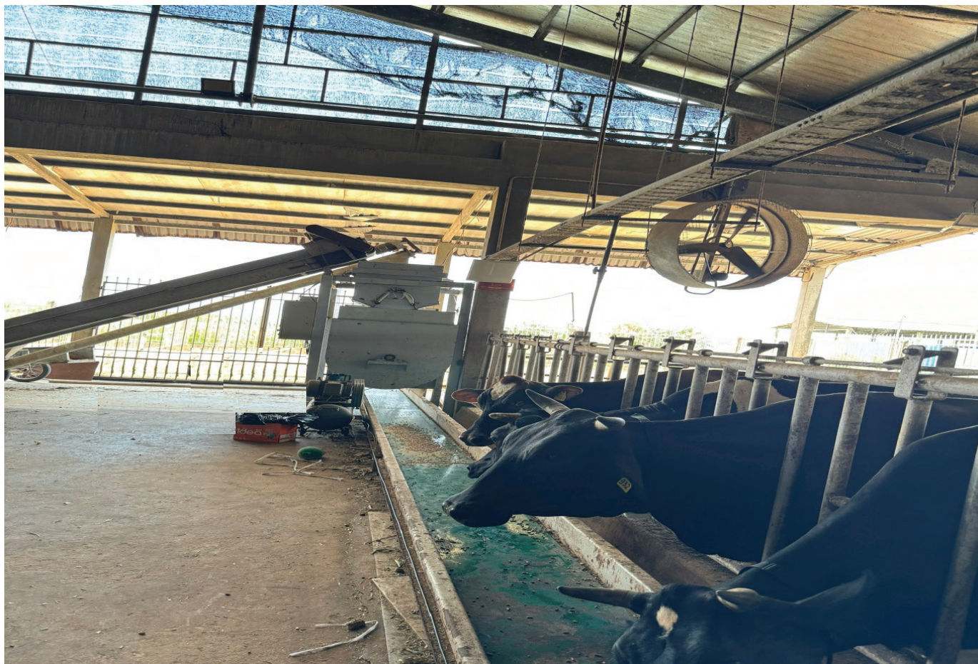
Hệ thống tự động cung cấp thức ăn và thu hồi thức ăn thừa trong trang trại bò sữa do Phân viện Nghiên cứu Điện tử, Tin học, Tự động hóa TP Hồ Chí Minh chế tạo.
